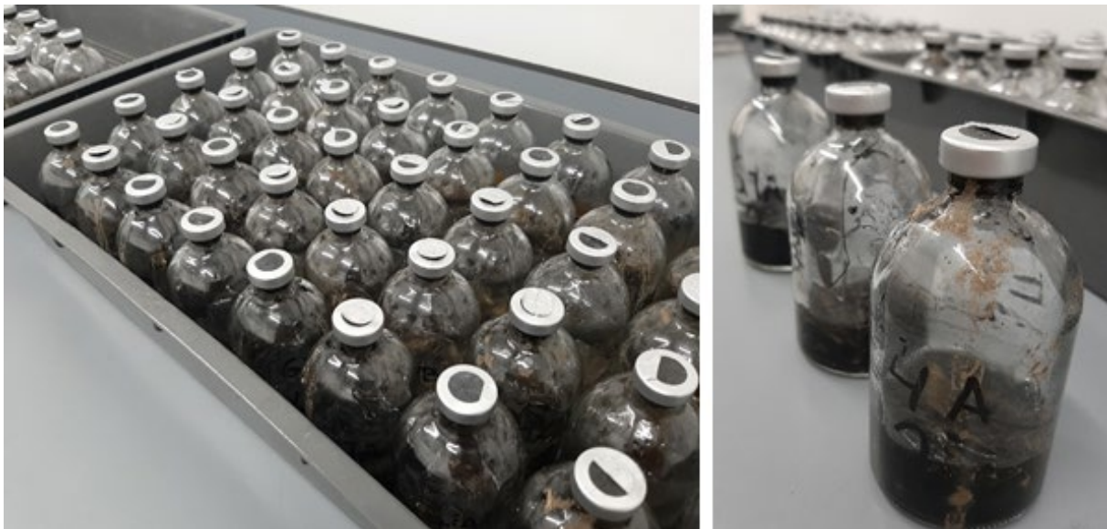
Figuur 2.2. Overzicht opzet incubatie experiment (links) en close-up van een van de incubatieflesjes (rechts).
